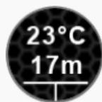
Температура и глубина воды при текущем положении эхолота
